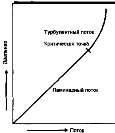
Рис. 15.11. Взаимоотношения давления и потока в жидкости являются линейными до критической точки, выше которой поток становится турбулентным
