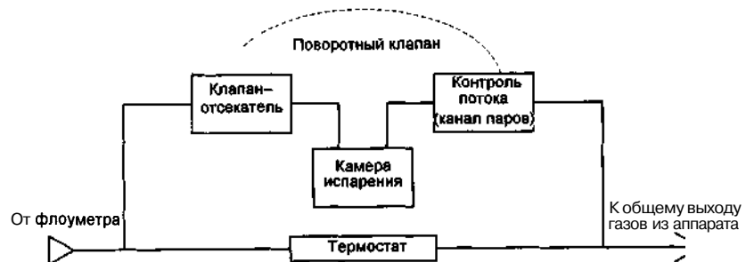
Рис. 16.б,б. Схема испарителя Mark 5 TEC
