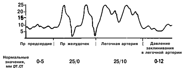
Рис. 20.18. Схематически представленные волны давления, наблюдаемые на осциллографе при прохождении кончика легочного катетера через правое предсердие и правый желудочек в легочную артерию. Волна «заклинивающего давления в легочной артерии» возникает при раздувании баллона в момент нахождения кончика катетера в ответвлении легочной артерии. Показанные нормальные значения представляют давление у пациента при спонтанном дыхании.
