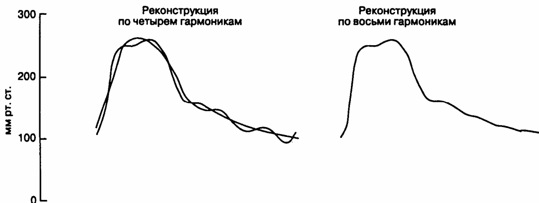
Рис. 6-13. На этих иллюстрациях представлено совмещение исходной пульсовой волны с реконструкциями, полученными с помощью анализа Фурье: слева реконструкция воспроизведена по четырем гармоникам, справа — по восьми. Следует отметить, что чем больше число гармоник, тем точнее реконструкция соответствует исходной волне. (Из:
