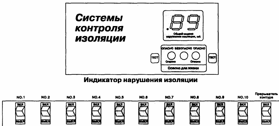
Рис. 2-9. Панель монитора изоляции электролинии (с разрешения Ohio Medical Products)
