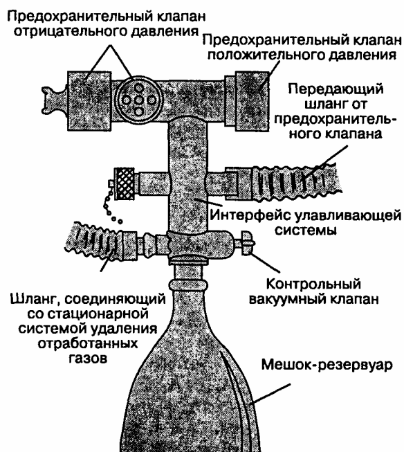
Рис. 4-12. Система улавливания отработанных газов
