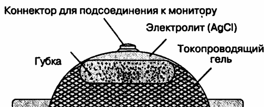
Рис. 6-17. Поперечный разрез хлорсеребряного электрода
